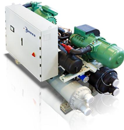
**Wassergekühlte Flüssigkeitskühler. Baureihe mit halbhermetischen Schraubenverdichtern mit variabler Drehzahl, Inverter-Steuerung und Kältemittel R513A.**
